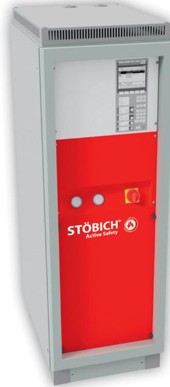
Die Niederdruckwassernebelanlage (NDWN) stellt eine umweltschonende Alternative zu vielen herkömmlichen Löschmethoden dar und findet in vielen unterschiedlichen Bereichen Anwendung. Durch den geringeren Verbrauch an Wasser und Strom arbeitet sie sehr effizient. Der durch Druck und spezielle Düsen erzeugte Wassernebel bekämpft Brände durch seine hohe Kühlleistung und dem Effekt der Sauerstoffverdrängung besonders gut und schnell.
